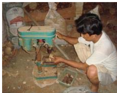
ขั้นตอนที่ 6 เจาะรูที่กะลาเพื่อใส่ซิป
